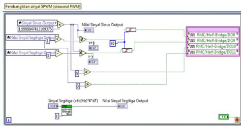
Fig. 6. SPWM Signal Generator
