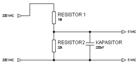
Fig. 2. Voltage sensor
