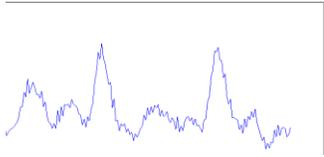
Data dari sensor denyut nadi dibaca melalui pin analog dari Arduino menggunakan waktu sampling sebesar 0,01 detik. Data dari sensor denyut nadi ini masih memiliki noise sehingga perlu difilter. Untuk menghilangkan noise pada sinyal dari sensor denyut nadi, maka digunakan sebuah low pass filter (LPF) orde dua dengan persamaan sebagai berikut:
