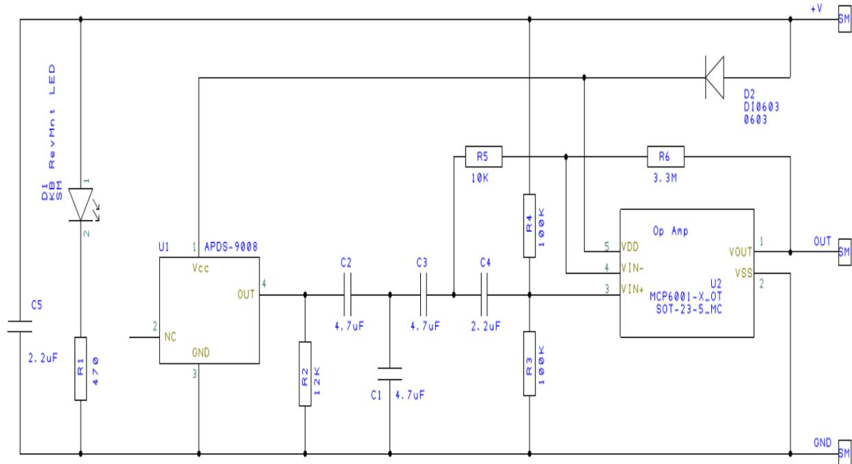
Keluaran dari sensor tersebut dapat langsung dihubungkan dengan mikrokontroler seperti Arduino. Data dari sensor itu dapat dibaca menggunakan fitur analog to digital converter (ADC) dari arduino.
