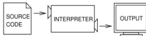
Gambar 4 interpreter memproses program lebih cepat, secara bergantian membaca kode dan memperlihatkan hasilnya
