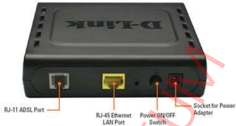
Gambar 4. Skema Konektor ADSL Modem
